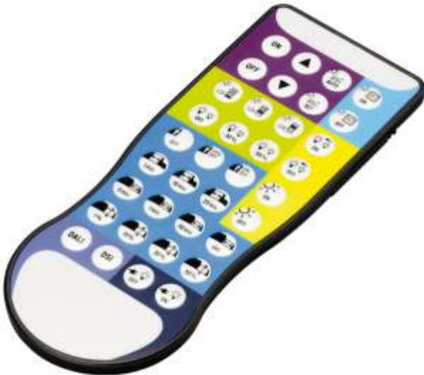
Mit dem basicDIM ILD Programmier können Einstellungen an der x.arris 4S und x.cite LED Stehleuchte vorgenommen werden. Folgende Parameter stehen zur Verfügung:
