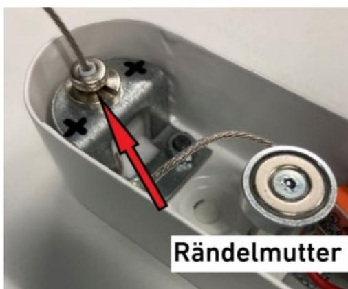
9. Seile ablängen, Seilenden 11mm abisolieren und an den entsprechenden Klemmen anschließen!
