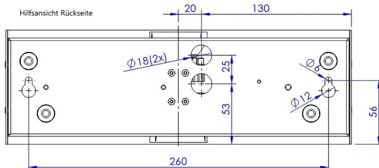
Die an der Leuchte vorhandenen Befestigungssicken dienen lediglich zum Ausgleich von Wandunebenheiten etc. Diese müssen zur Montage der Leuchte nicht verwendet werden.
